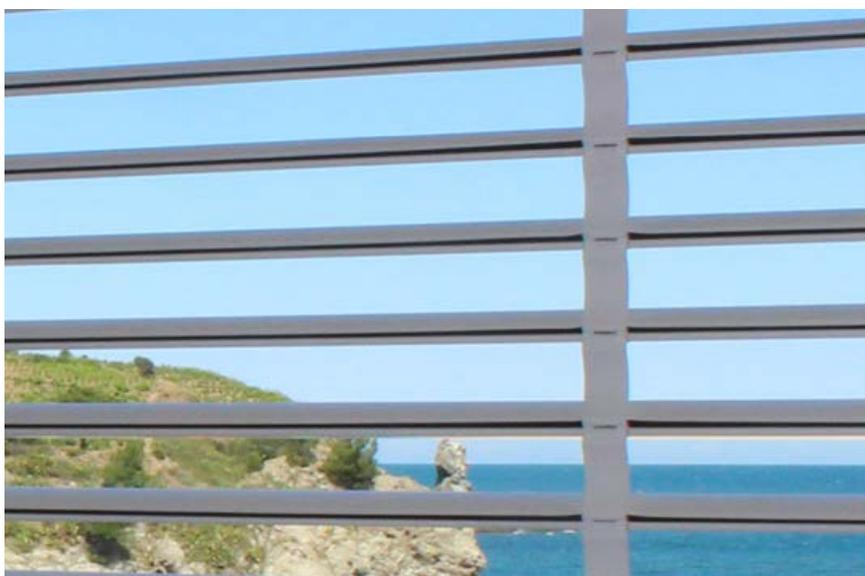
Pour les largeur supérieure à 2300mm le tablier doit avoir des supports intermédiaire de la même couleur des lames afin d'éviter le fléchissement.
